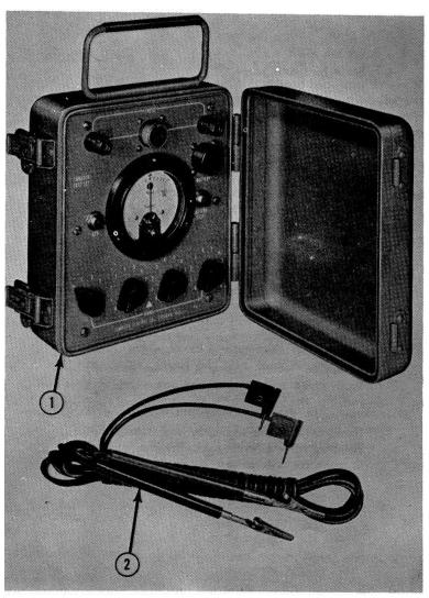
FIGURE 4. SIMPSON IGNITER TEST SET
